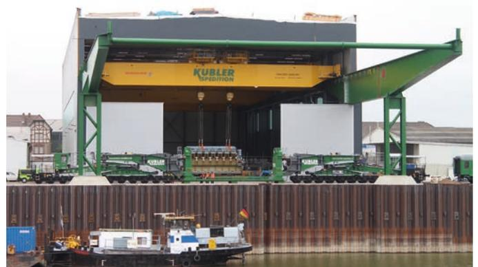
Das Kübler-Schwergutzentrum im Rheinauhafen schlägt mit einem 500-t-Hallenkran einen schweren Schiffsmotor vom neuen Bahntieflader in die Montagehalle um. Dort wird der Motor endmontiert, um ihn dann in ein Binnenschiff zu verladen. Foto: Kübler
